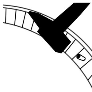
Tapotez le cône en bois dans le trou avec sensibilité jusqu'à ce qu'il ne puisse plus être enfoncé plus loin.
