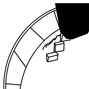
Placez les cales en bois dans le trou et tapez-les avec précaution jusqu'à la butée.
