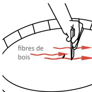
En cas de fuite sur le couvercle du fût, marquez l'endroit et placez un ciseau à bois environ 1 cm derrière ou devant la fuite, perpendiculairement au sens des fibres, et faites un trou à l'aide d'un marteau.
